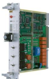
Бесконтактный модуль управления электроприводом
